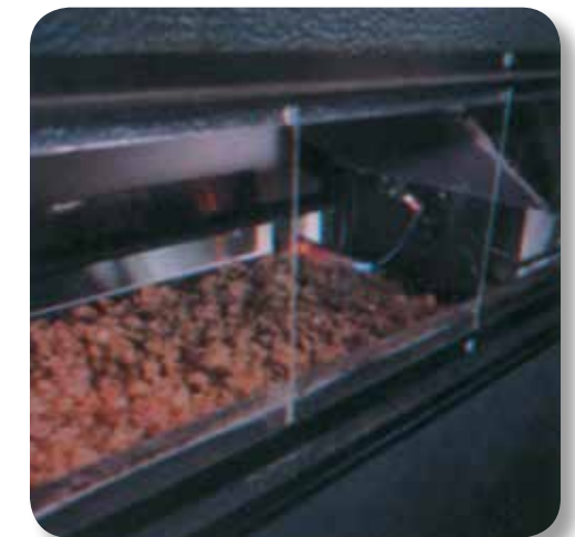
Les isolants en fibre de verre, en vrac et en nattes, réussissent régulièrement l'essai de résistance au feu ASTM E970.
