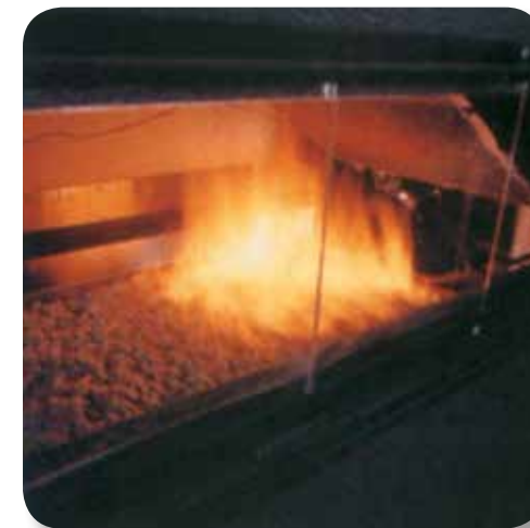
Certains échantillons de cellulose ont échoué l'essai de résistance au feu de ASTM E970 six mois seulement après leur installation.
